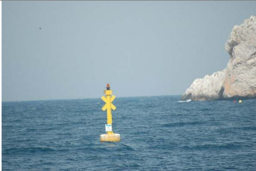
Εικόνα 1: Φωτοσημαντήρας οριοθέτησης του ΚΠ.
